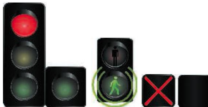
Сигналы светофора: круглый, в виде силуэта пешехода, X-образный
