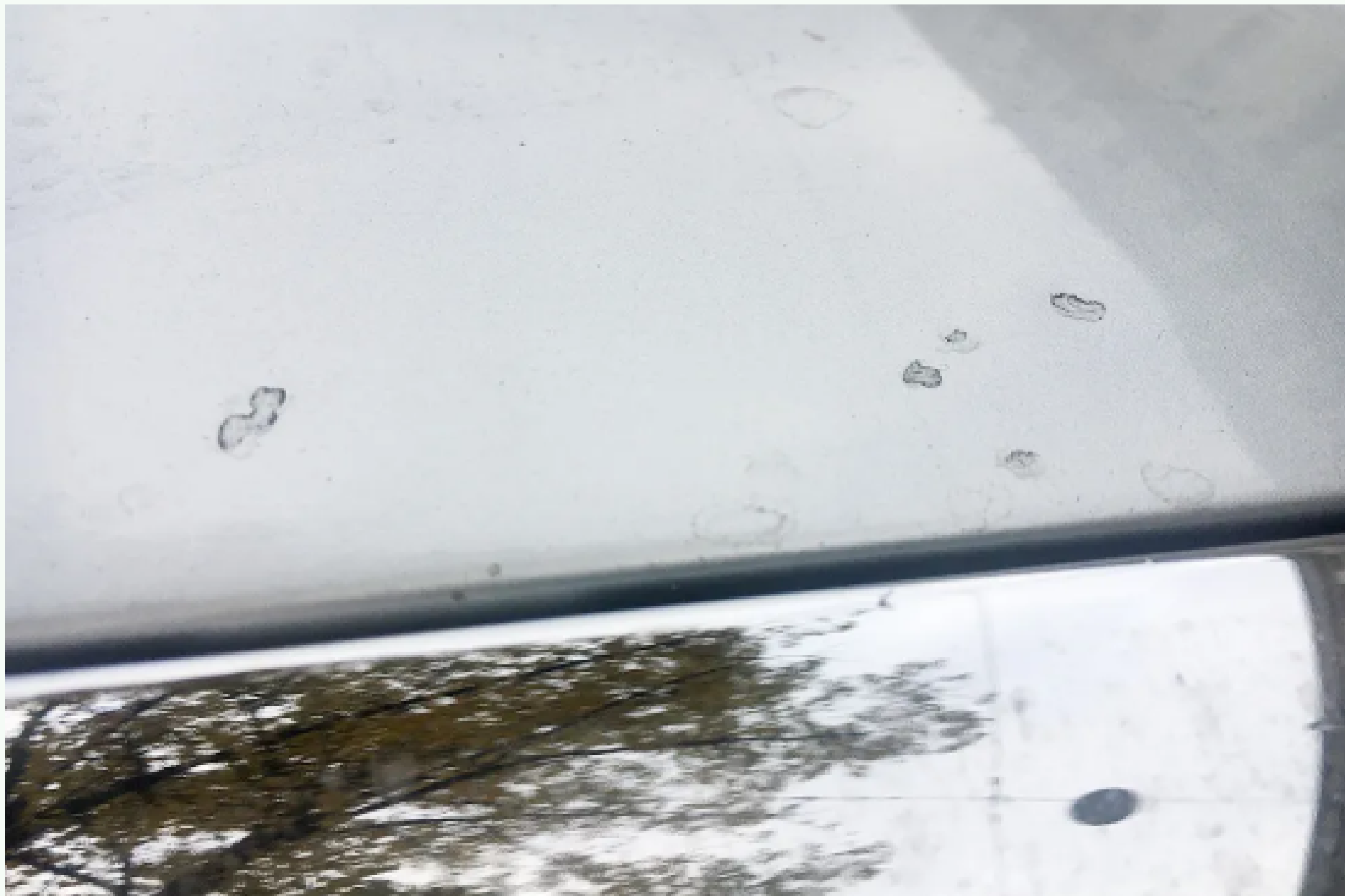
Сколы на капоте, которые перекуп подмазал серебрянкой или специальным маркером. Заводская краска откололась, но под ней оцинкованный металл, поэтому ржавчины нет
