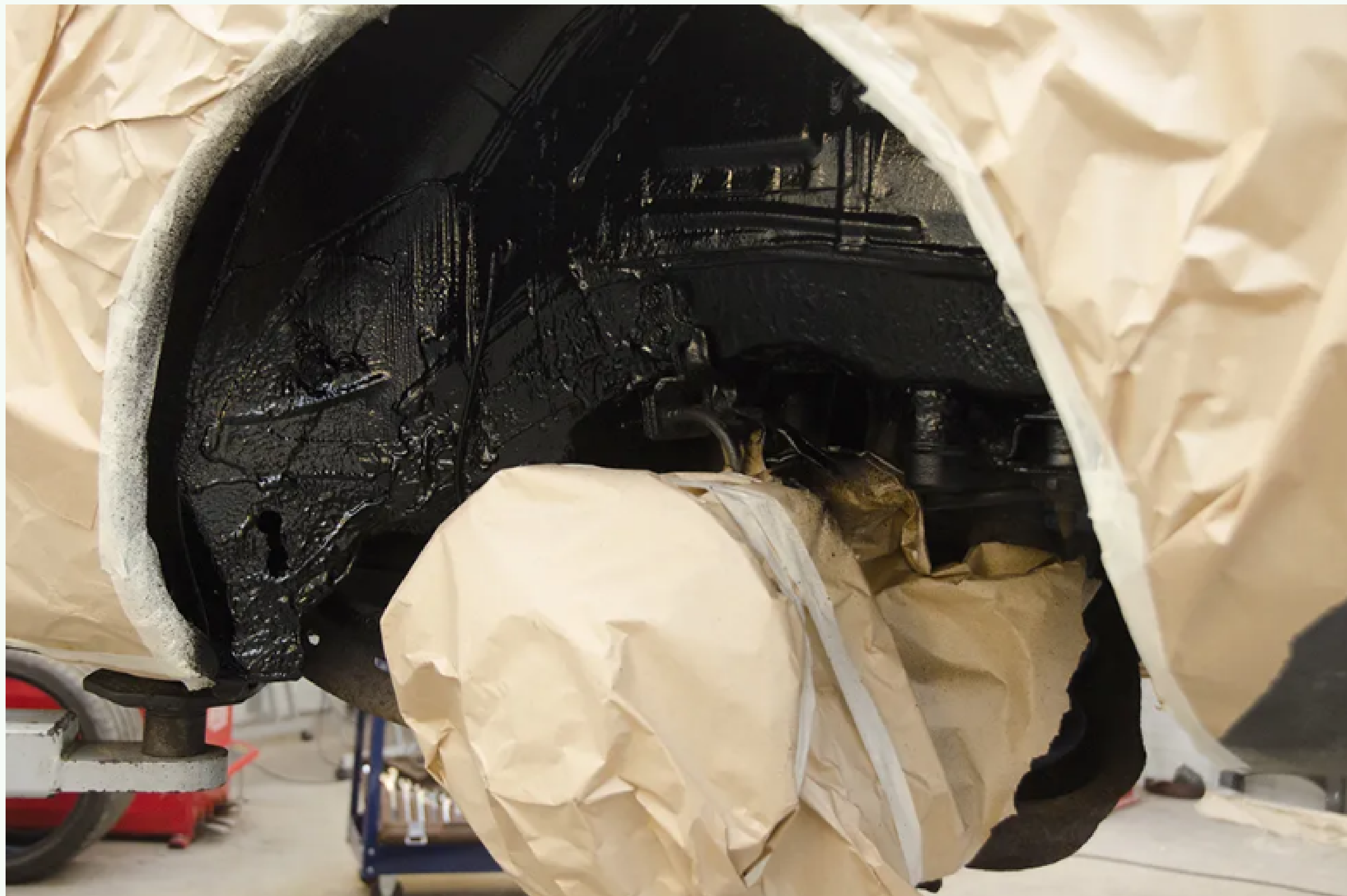
Так выглядит колесная арка после обработки битумным антикоррозийным составом.
