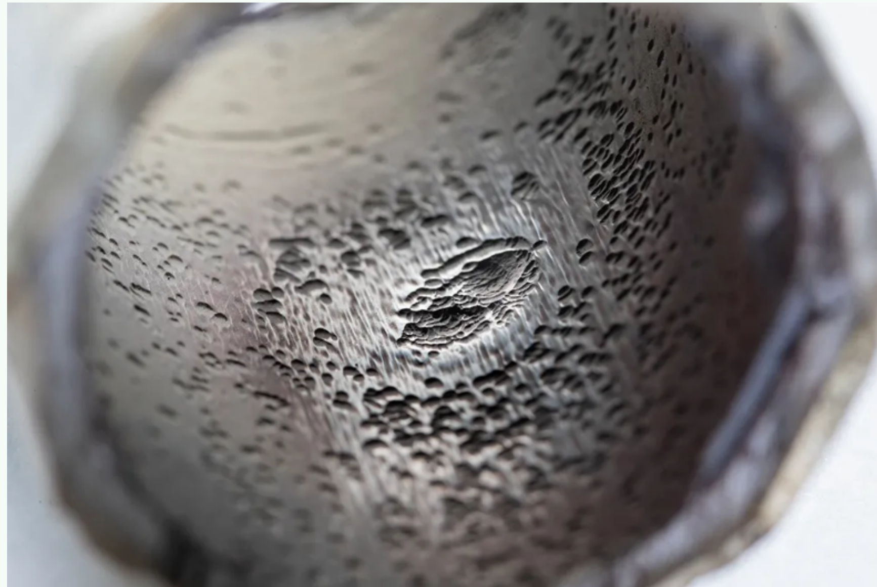
Так кавитация в антифризе воздействует на металл, разрушая стенки цилиндров.
