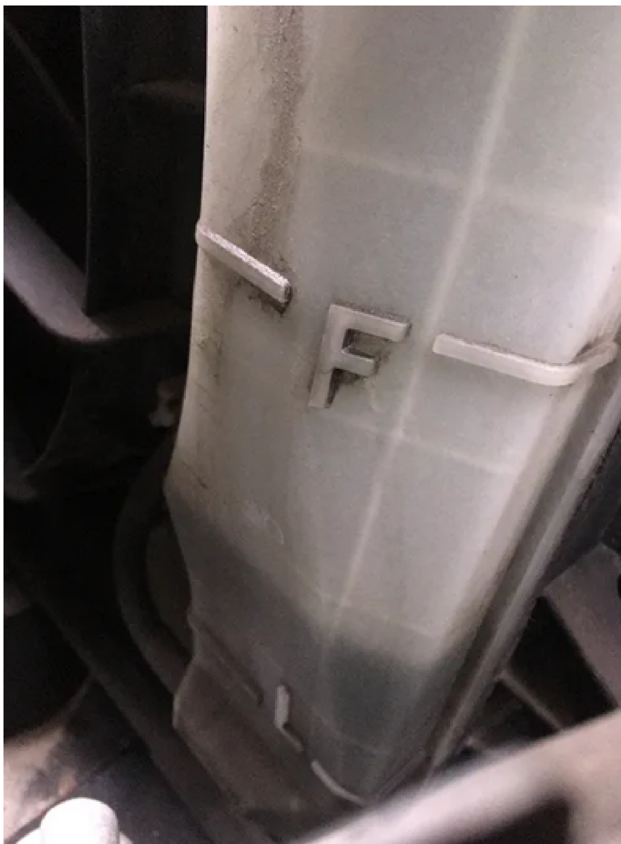
Расширительный бачок Hyundai Creta. Уровень антифриза в норме — между отметками F и L
