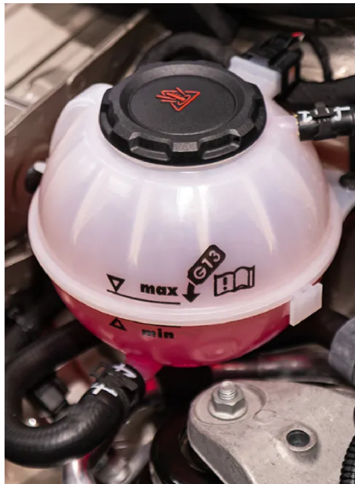
На расширительном бачке обозначен допустимый тип антифриза G13 и максимальный и минимальный уровень. Фото: Everyonephoto Studio / Shutterstock
