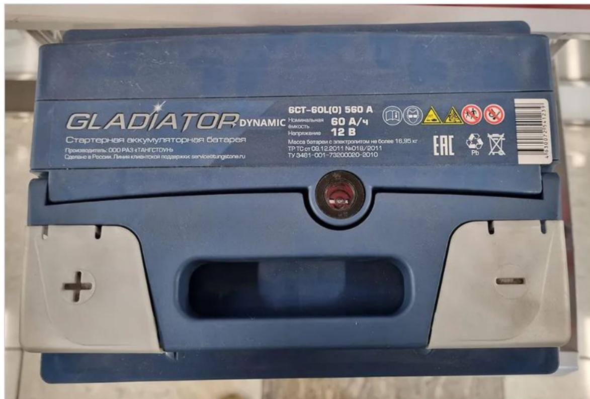
В зависимости от производителя индикатор на аккумуляторе может быть двух- или трехцветным. Он подскажет, когда АКБ нужно зарядить или долить электролит, если батарея обслуживаемая
