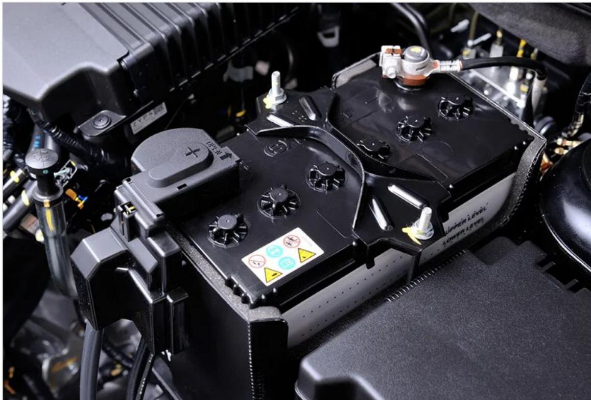
Верхнее крепление аккумулятора: специальная рамка или пластина прижимает его к площадке сверху через два болта или шпильки. Фото: Nor Gal / shutterstock
