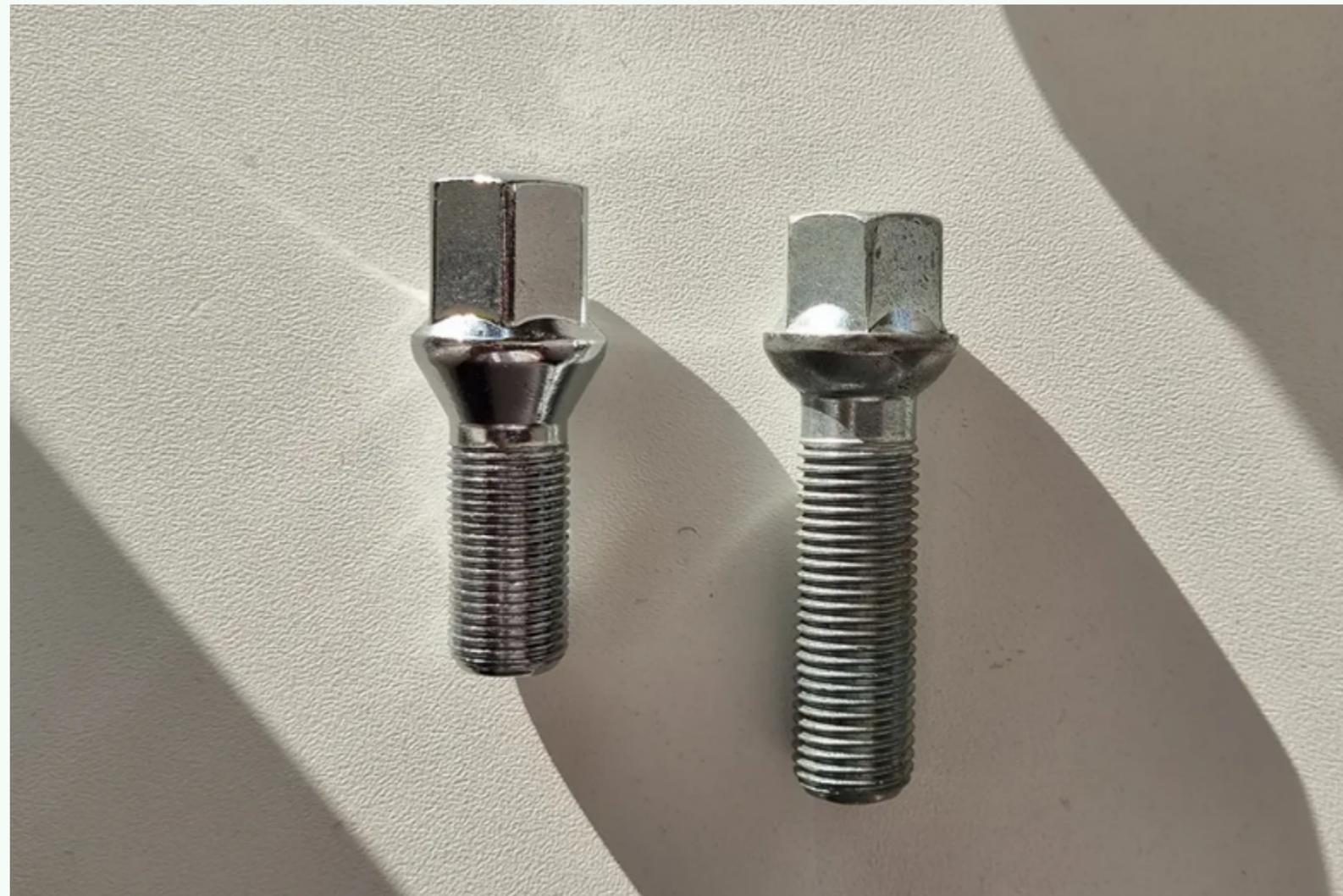
Узнать, какой формы отверстие, можно только при осмотре диска, производители не обозначают этот параметр. Слева — болт типа «конус», справа — «полусфера». Если болты придется менять ради новых дисков, это не сильно повлияет на бюджет
