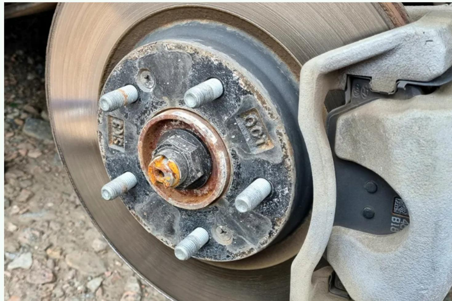
Ступица со шпильками, колесо в таком случае фиксируют гайками. Выступ на ступице позволяет правильно установить не только диск колеса, но и тормозной диск
