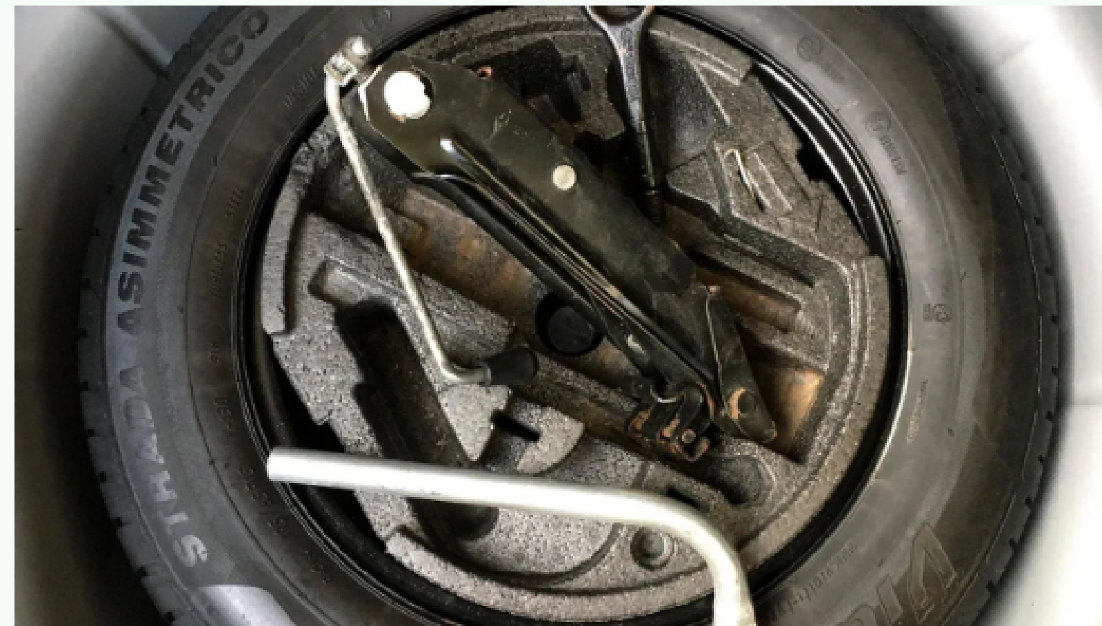
Полноразмерное запасное колесо с органайзером из пенопласта, который фиксирует рожковый ключ, домкрат и буксировочную проушину
