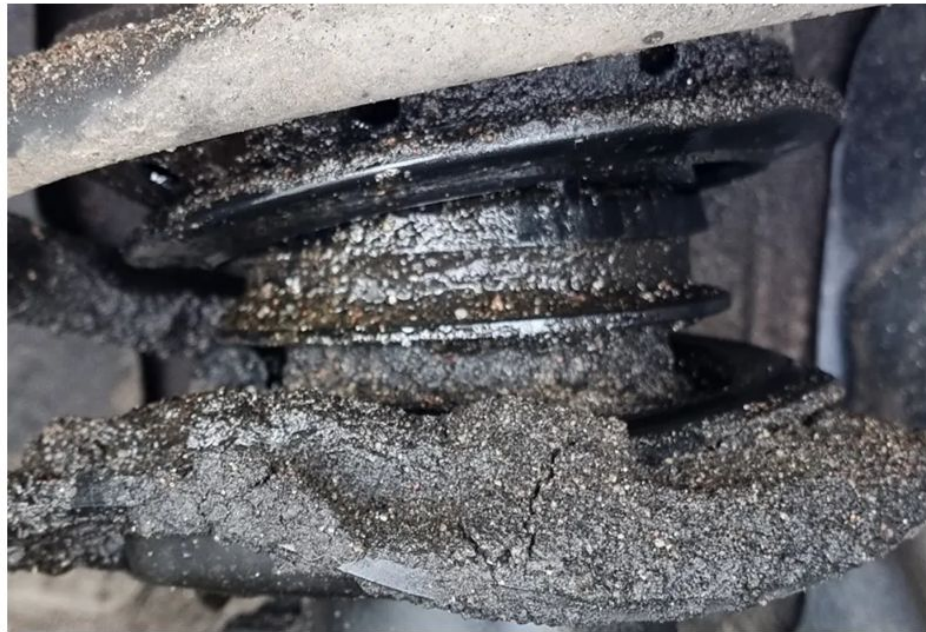
Чтобы увидеть течь масла из амортизатора, не обязательно снимать колесо. Так выглядит неисправный передний амортизатор Mini JCW на пробеге 100 000 км
