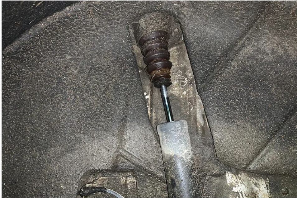
А так выглядит отбойник, который пропитался маслом из амортизатора. Видите такой — меняйте амортизаторы на оси. Конкретно этот отбойник ко всему прочему не фиксирует пыльник
