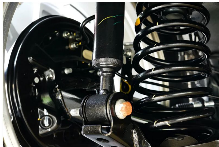
Задняя подвеска Хонды Цивик. Амортизаторы могут разместить внутри пружины, а могут расположить рядом, только пружин или только амортизаторов быть не может. Фото: M181 / Shutterstock
